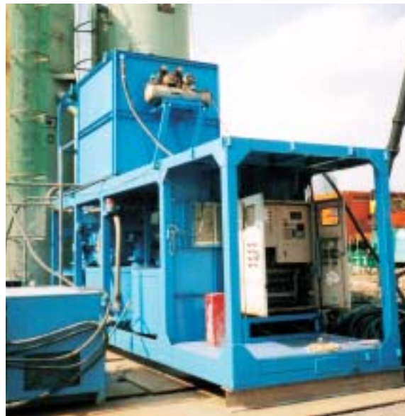
■ スラリープラント
